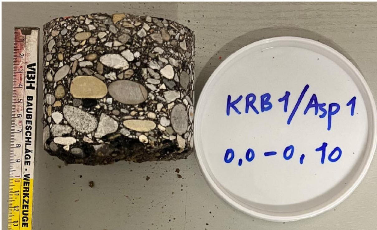
**Abb. 1, 19.12.2023: Fahrbahnbefestigung bei KRB 1
