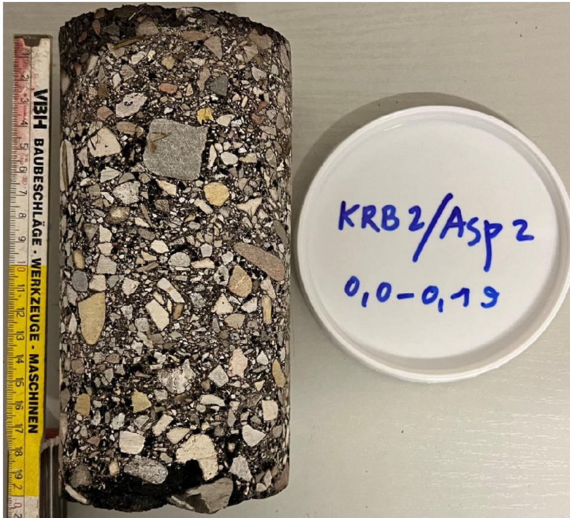
**Abb. 2, 19.12.2023: Fahrbahnbefestigung bei KRB 1
